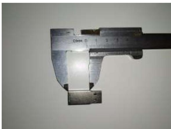
Флешка имеет высоту 5 мм и ширину 14 мм. Это не слишком далеко от стандартов USB-накопителей. Длина её составляет 20 мм. Корпус флешки должен быть 35 мм x 20 мм x 11 мм с отверстием в 20мм x 14мм x 5мм .
